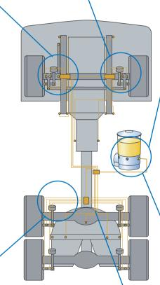
O exemplo mostra um sistema de lubrificação automática progressiva em um cavalo-mecânico. Dependendo das recomendações de seu fabricante de equipamentos originais, também é possível instalar um sistema de lubrificação de linha única SKF que funcione com graxa fluida.
