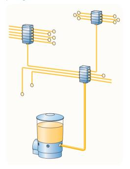
Em sistemas de lubrificação automática progressiva, uma bomba de pistão fornece uma determinada quantidade de lubrificante através da linha principal para o dispositivo de dosagem que atua em cada saída. Os sistemas SKF ProFlex e Lincoln Quicklub foram projetados para aplicações específicas e podem ser configurados para atender aos requisitos exclusivos de cada ponto de lubrificação no equipamento.
