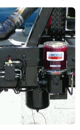
Além de manter o filme lubrificante certo para reduzir o desgaste, a lubrificação frequente atua como um meio de eliminar os agentes de contaminação dos componentes do chassi e da carroceria. Se for permitido que poeira, sujeira, areia e água penetrem nesses componentes, um "composto de retificação" será formado, reduzindo consideravelmente a vida útil do rolamento.
